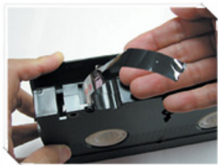
圖1：錄影音帶劣化情形乙酸綜合症(脆化現象)
